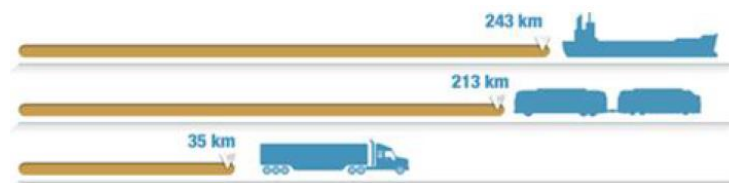
Figura 11: Distância percorrida por tonelada para 01 (um) litro de combustível Fonte: Câmara de Comércio Marítimo – Canadá/EUA
